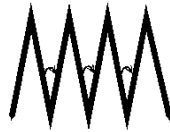
Fig. 16: Längenmessen durch Abschlagen
