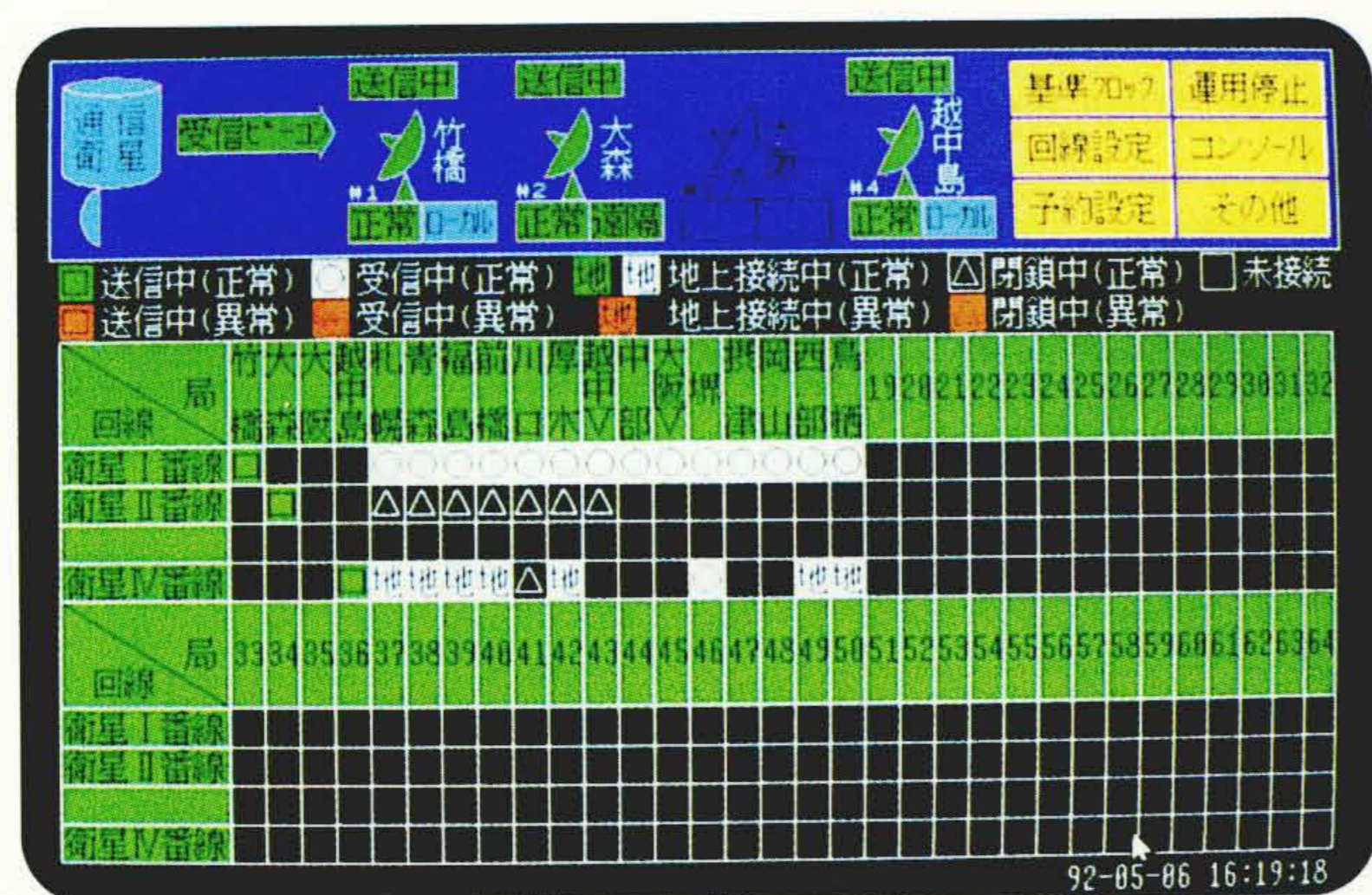
図4 コンソールの運用画面 運用画面でシステムの運用状況や障害状況が監視でき、マウスでメニュー選択を行うと設定画面へ移行する。
