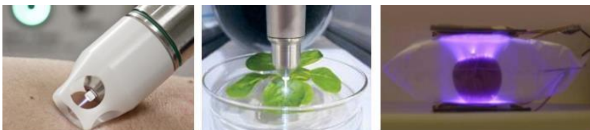
Abb. 4.2.15: Plasmaanwendungen (Von links nach rechts: Plasma-Pen zur Wundheilung der Firma neoplas; Plasmajet auf Lebensmitteln; CP- inpack -Anwendung) (neoplas tools GmbH, 2011; ATB, 2011; Astley, 2011)
