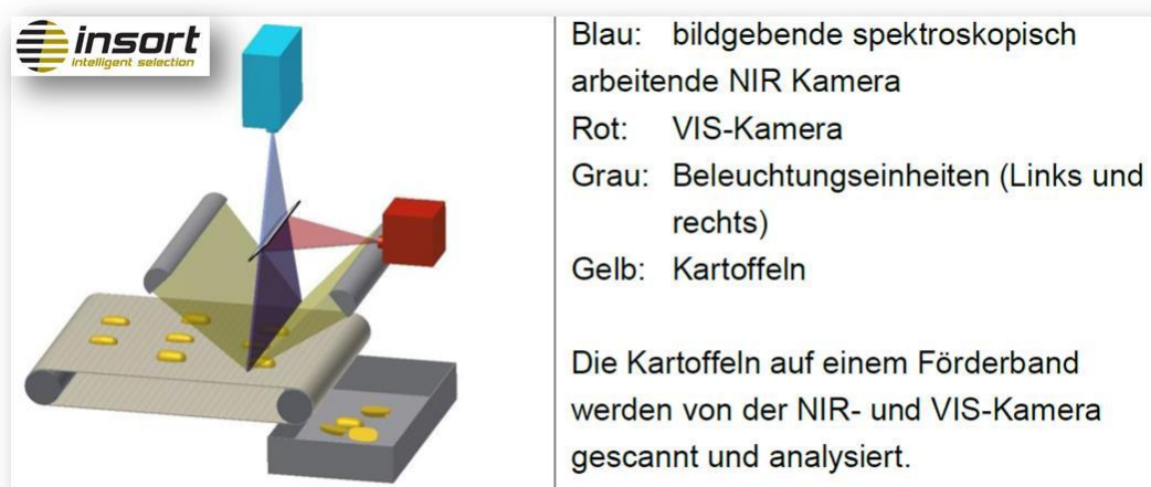
Abb. 6.2.1: Prinzip der bildgebenden Spektroskopie ( hyperspectral imaging ) (INSORT, 2015)
