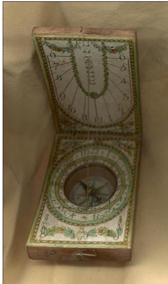
Abbildung 70: Klapp- oder Taschensonnenuhr, ca. 1805. Mit selbiger läßt sich auch die Zeit der Taschenuhr einstellen.
