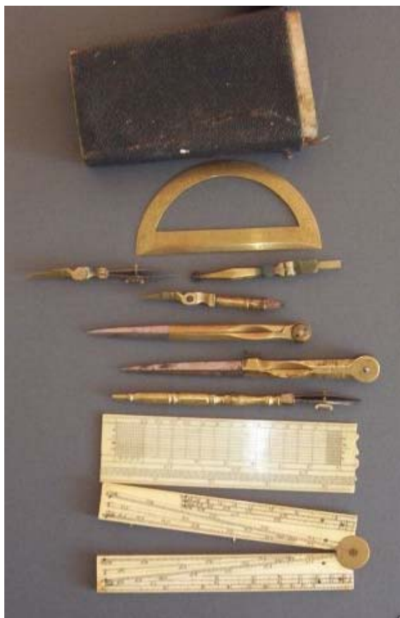
Abbildung 73: Mathematisches Taschenbesteck mit Zirkeln, Ziehfeder, Transversalmaßstab, Proportionalzirkel (England, Ende des 18. Jahrhunderts)
