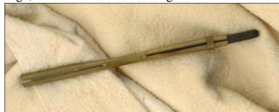
Abbildung 59: Port-crayon mit eingespannter Kohle, wie solcher meist den mathematischen Bestecken beigegeben ist.
