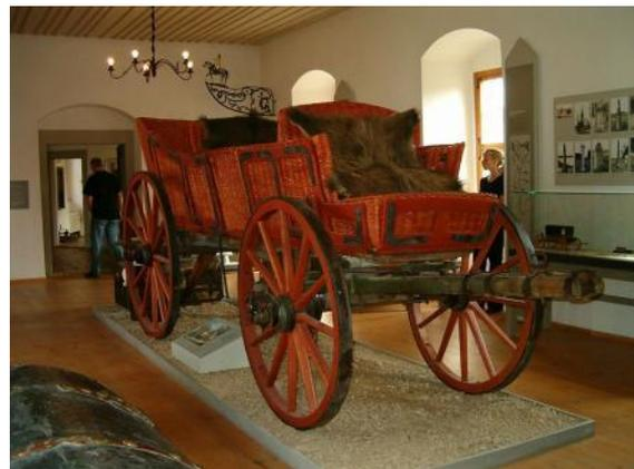
Abbildung 52: Nachbau eines Korbwagens als Postkutsche von ca. 1800. Man beachte die fast gleich hohen Vorder- und Hinterräder. Die ersteren können nicht unter das Chassis einschlagen, also ist die Manövrierfähigkeit eingeschränkt.
