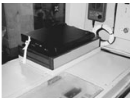
図22 ホーム検知装置用記録装置
