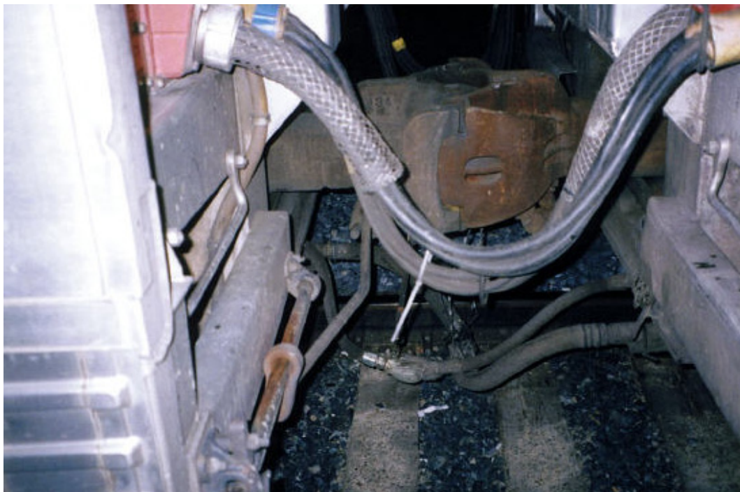
Figur 8 Tightlock koppel i Amtracks tåg California Zephyr på linjen Chicago - San Fransisco
