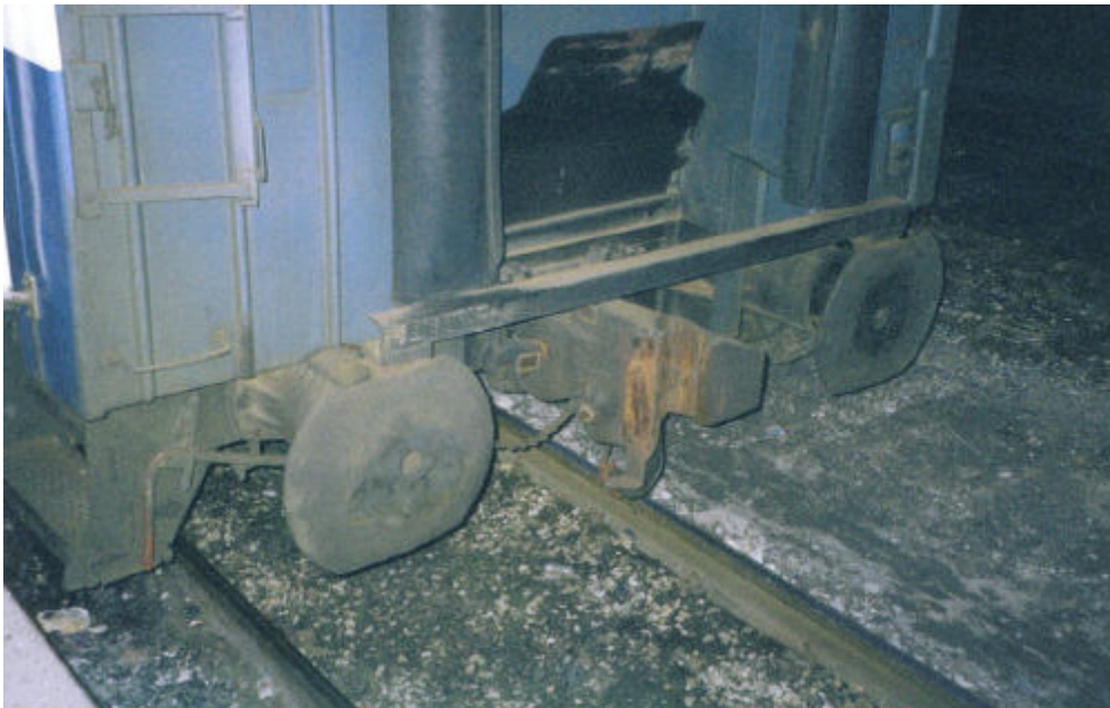
Figur 13 Personvagn med SA-3 koppel och buffertar samt en bärande balk för gångbryggan
