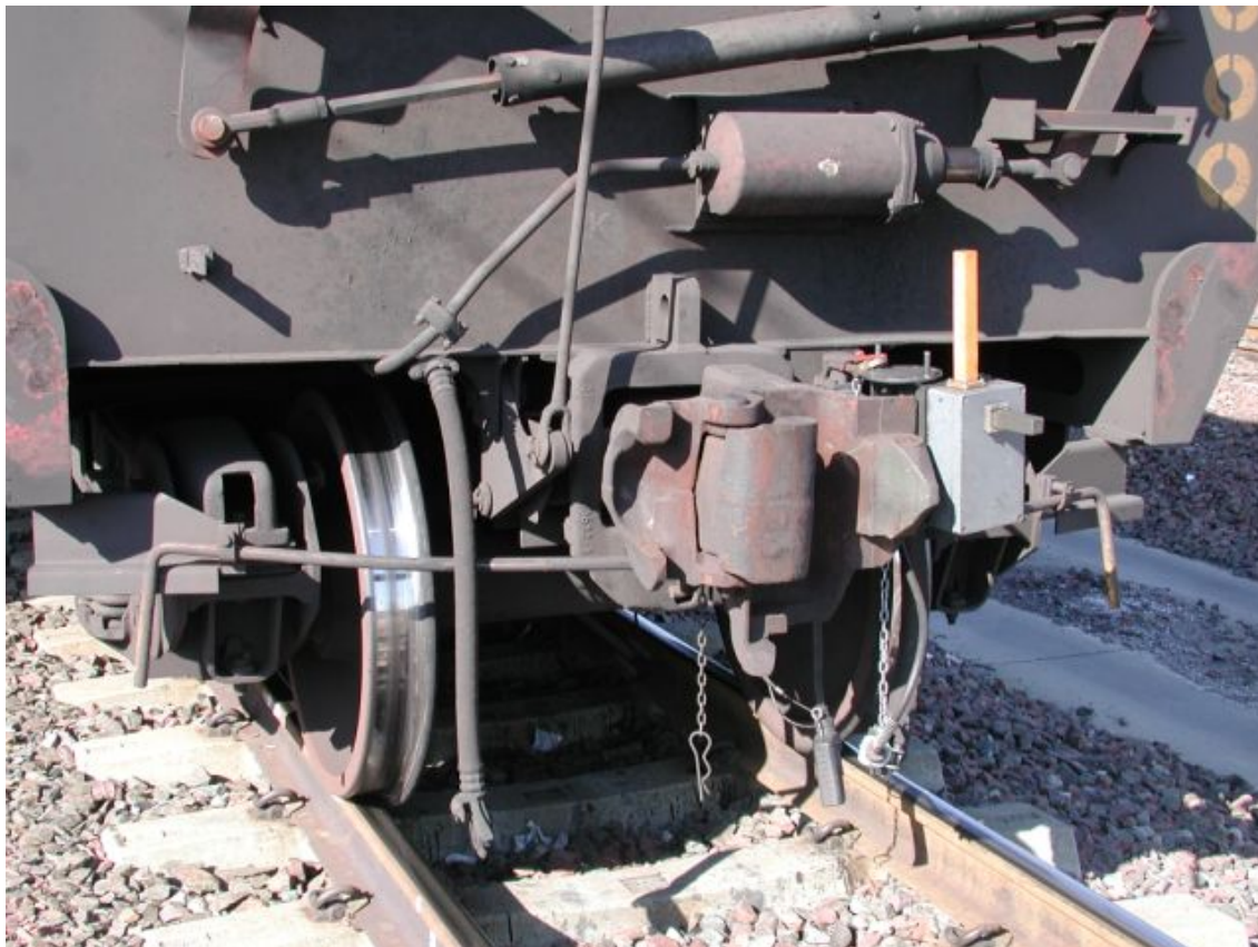
Figur 5 Stelt Janneykoppel typ F på en Sydafrikansk vagn för koltransporter
