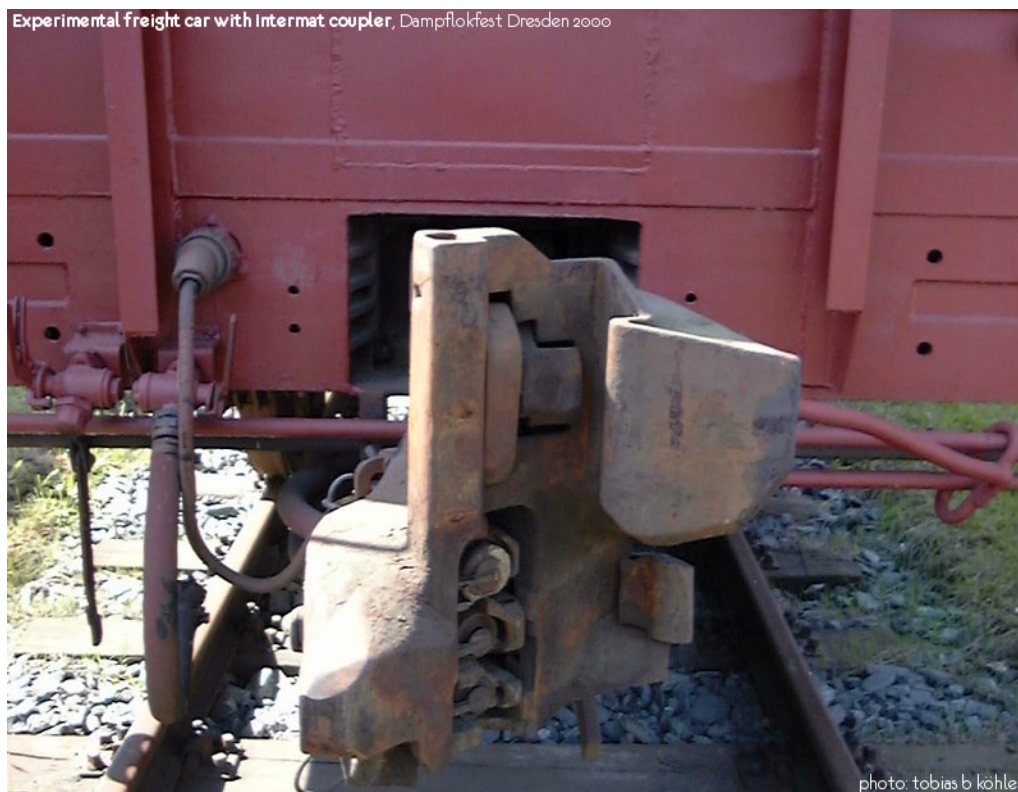
Figur 16 Kopplet Intermat med styrhorn och lågt placerade luft- samt elledningar
