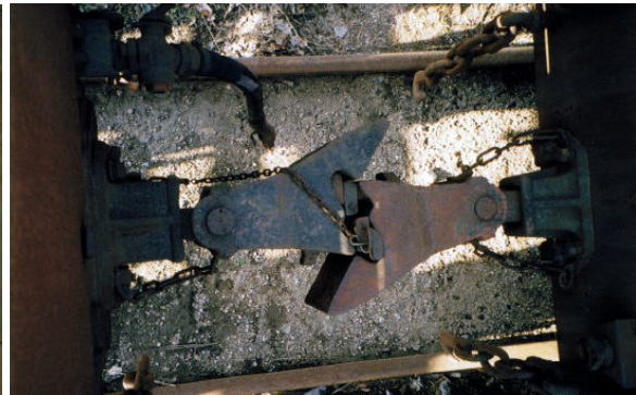
Figur 8 NKIJ koppel med gafflarna på plats
