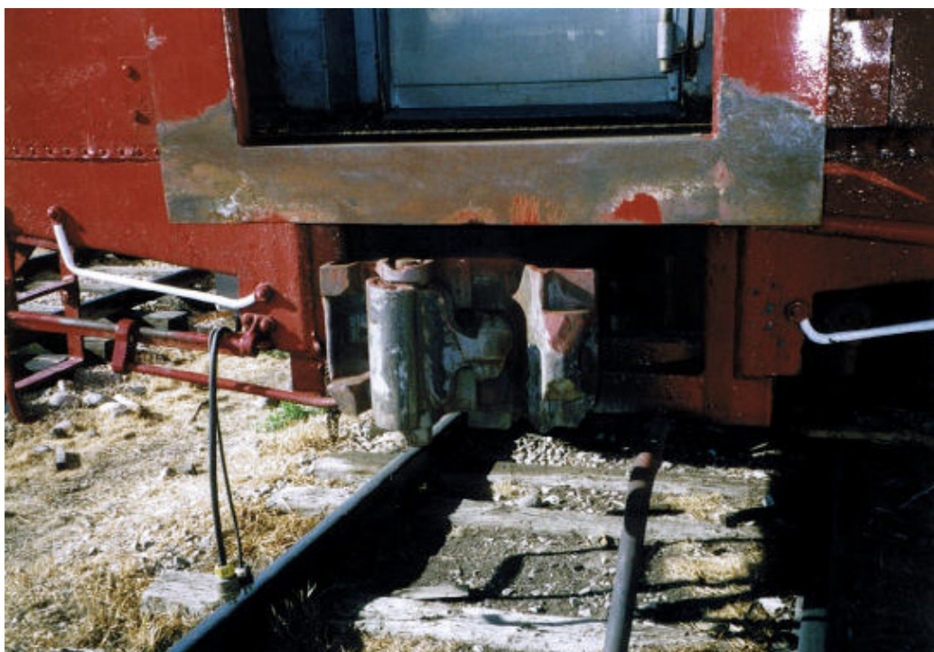
Figur 7 Tigt Lock koppel med klon i öppet läge färdig för hopkoppling. Längst t.v. och t.h. är de kontaktytor som tillkommit och som inte finns på det vanliga Janney-kopplet
