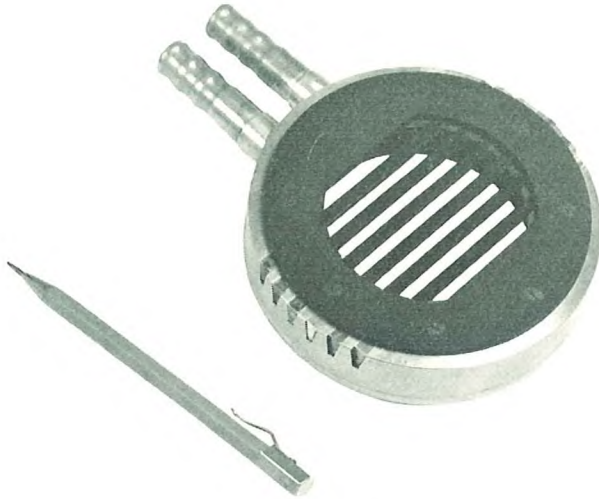
Abb.8 Fertig bearbeitetes Gegenblendensystem. Die Auffangbarren sind geschwärzt. Um die Energie des absorbierten Lichtes abzuführen, ist das System wassergekühlt.
