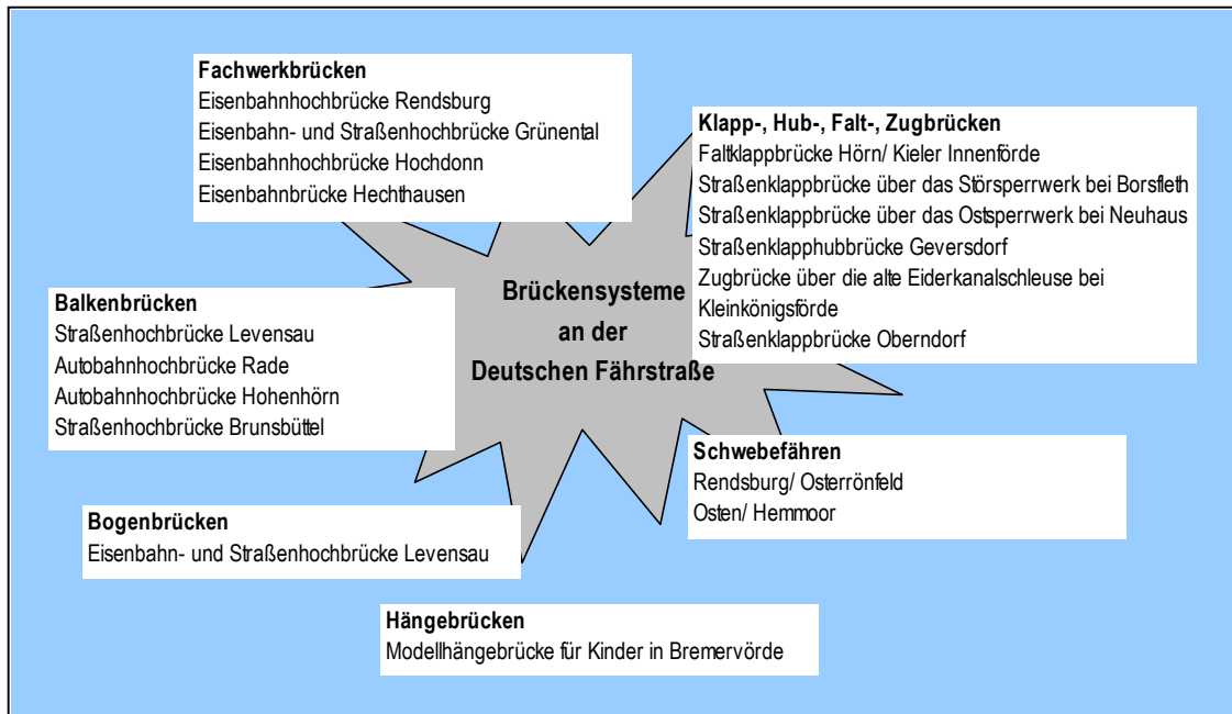
Abbildung 3.4-3: Systematik der Brücken der Deutschen Fährstraße nach ihrem Konstruktionstypus. (eigene Darstellung)
