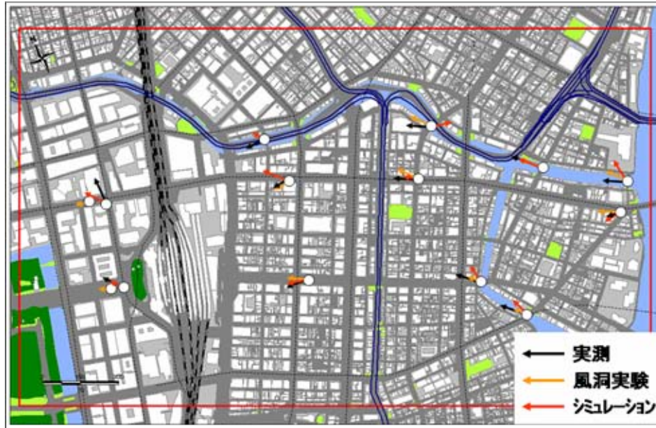
図 4-3-12 数値解析結果と実測調査並びに風洞実験結果との比較（風向・風速）
