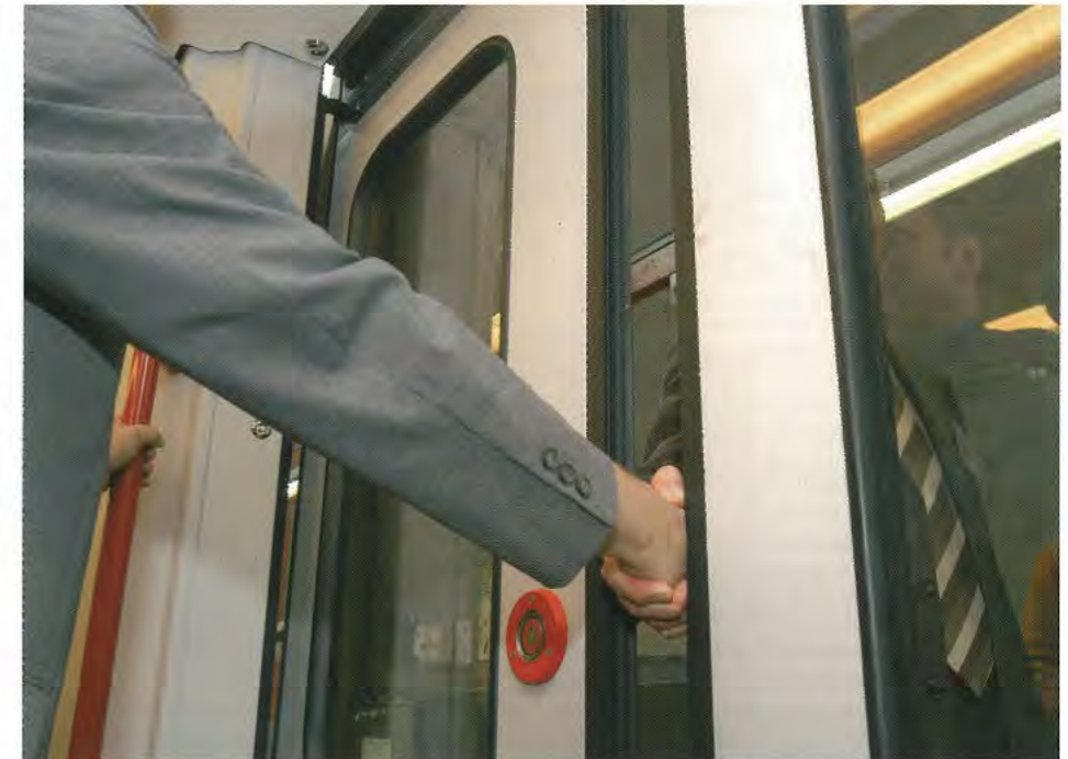
Sensiblen Türkanten erkennen auch die eingeklemmten Hundeleinen oder den Schal und stoppen der Zug noch in der Anfahrt.
