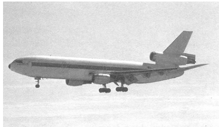
Σχήμα 2.37 Το τμήμα εισαγωγής αέρα θεωρείται μέρος του κινητήρα όταν αυτός τοποθετείται στα πτερύγια του αεροσκάφους
