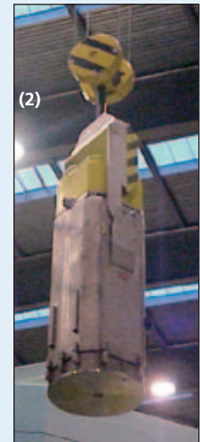
NEURAP-Aufbau mit Abschirmblock (1) und Wechselflasche (2). NEURAP dient zur Untersuchung hoch radioaktiver Proben, zum Beispiel Brennstäben.
