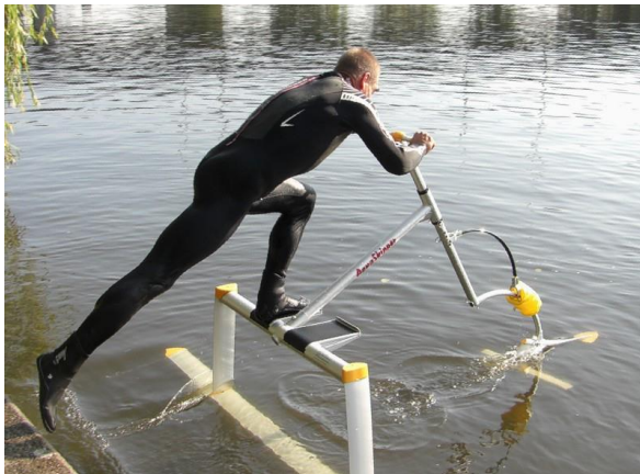
Muskelkraftbetriebener "Aquaskipper": Vortrieb wird durch rhythmisches Hüpfen erzeugt, entsprechend dem Auf und Abschlagen einer Schwimmflosse
