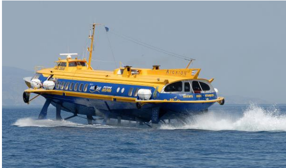
Tragflügelboot Vortrieb wird durch Wasserstrahldüsen erreicht
