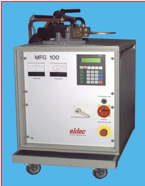
**eldec** MFG 100 in IGBT-Transistortechnik in mobiler Ausführung, mit Koaxialtransformator mit 5 bis 10 m flexibler Zuleitung.
