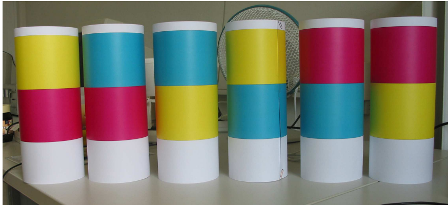
Abbildung 6.4: Die für das Navigationsmodul verwendeten Landmarken. Eine Landmarke enthält eine Auswahl aus den Farben magenta, cyan und gelb.
