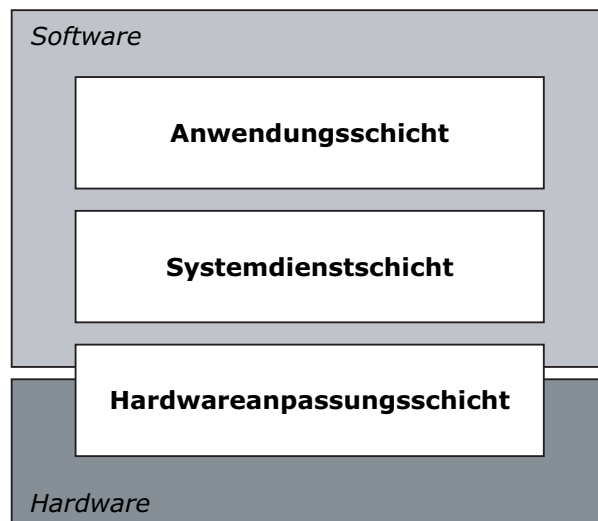
Abbildung 3.4: Ebenenstruktur der Open Architecture for Robot Entertainment.
