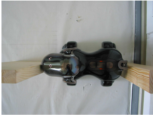
(a) Für den Test des Kopfabstandssensors für weitere Entfernungen wurde Aibo an der Niete an seinem Schwanz und an seiner Kamera ausgerichtet.
