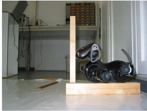
(b) Bei der Untersuchung des Kopfabstandssensors für nahe Entfernungen konnte Aibo durch eine geeignetere Vorgehensweise genauer positioniert werden.
