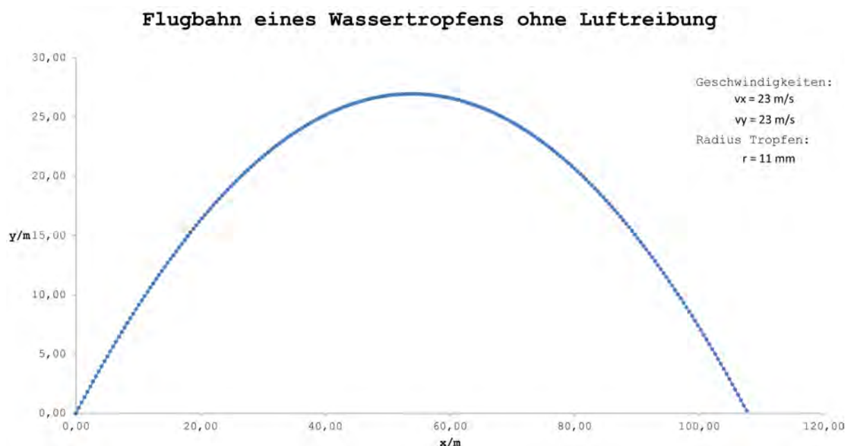
Abbildung 9.1.: Flugbahn eines Wassertropfens ohne Luftreibung.
