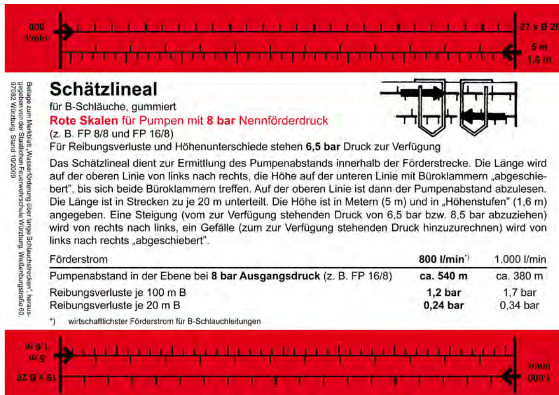
Abbildung 8.13.: Schätzlineal für B-Druckschläuche gummiert 160
