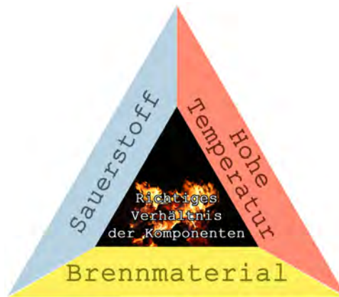
Abbildung 2.17.: Das vollständige Verbrennungsdreieck
