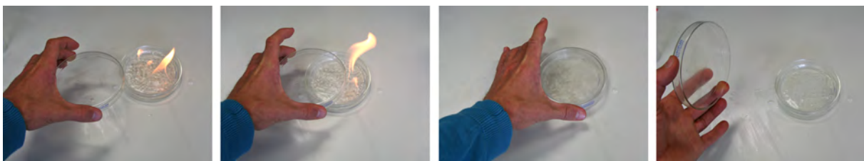
Abbildung 3.4.: Ersticken einer brennenden Flüssigkeit
