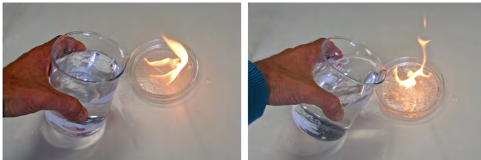
Abbildung 3.3.: Versuch: Brennendes Lampenöl mit Wasser löschen
