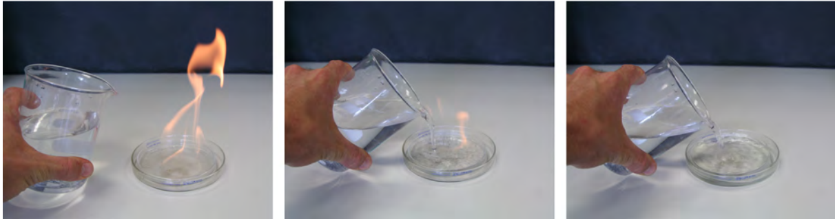
Abbildung 3.2.: Versuch: Brennenden Spiritus mit Wasser löschen
