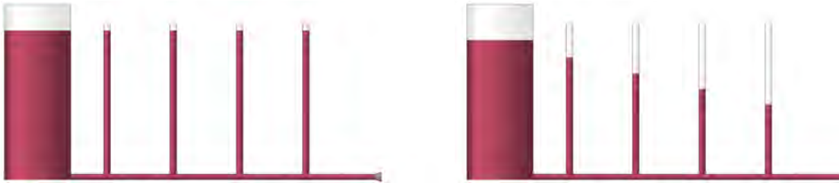
Abbildung 8.6.: Links: Druck entlang einer Röhre mit einer ruhenden Flüssigkeit Rechts: Druck entlang einer Röhre mit einer strömenden Flüssigkeit
