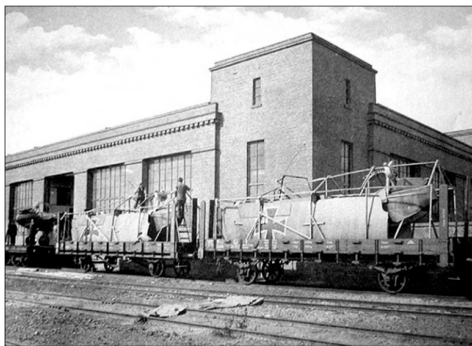
In ihre Einzelteile zerlegt, wurden die Flugzeuge mit der Bahn an ihren Bestimmungsort transportiert.
