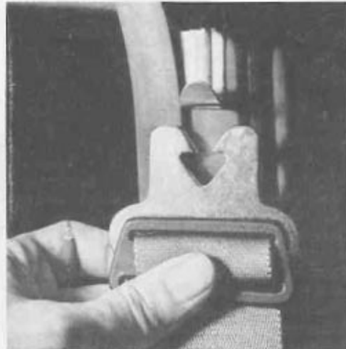
Bild 18 - Dieser kleine Leichtmetallbügel erfüllt die Funktion als Aufnahmehaken besser als die in anderen Fahrzeugen verwendete Plast-Abdeckkappe mit angegossenem Profil (Fotos Bilder 3 und 14 bis 18: Wonneberger)
