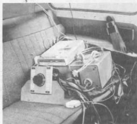
Bild 2 Die Meßwerte wurden während des Schnell- und Warmfahrt nach jeder vollen Minute von den 9 Meßstellen abgerufen und auf Band gesprochen. (Foto: Sander)
