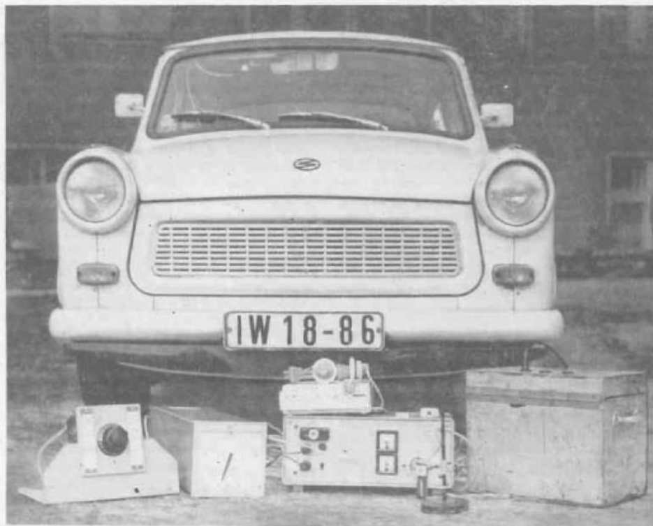
Bild 1 Meßgeräte zur genauen Temperaturbestimmung an verschiedenen Meßstellen von dem Trabant-Vergleichsfahrzeug aus dem Baujahr 1973
