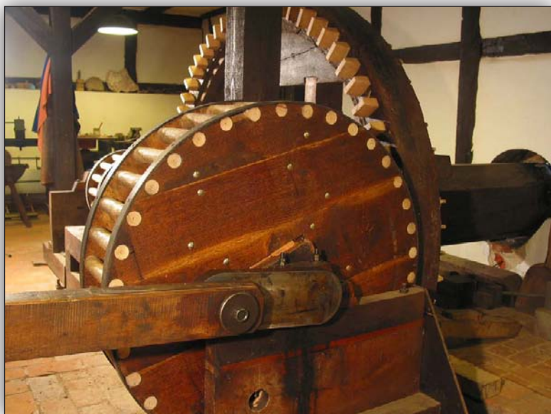
18- La vieja máquina de esmerilado de Schwerin. La transmisión de fuerza a través de una corona sobre un piñón y una biela hasta el marco de corte, corresponde en lo esencial a la figura del relieve de Amiano. La diferencia consiste en la rueda dentada que se aprecia en el relieve y que aquí se trata de una corona.
