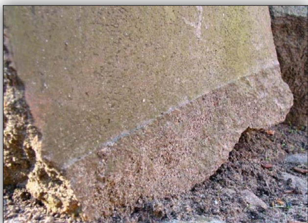
25-La pieza de Schwerin muestra claramente la línea de corte cuando la sierra es guiada en horizontal y en vertical. Los extremos están ligeramente caídos debido al movimiento brusco en el cambio de dirección del corte, que se introduce un poco más al cortare. La parte izquierda de la pieza está rota.
