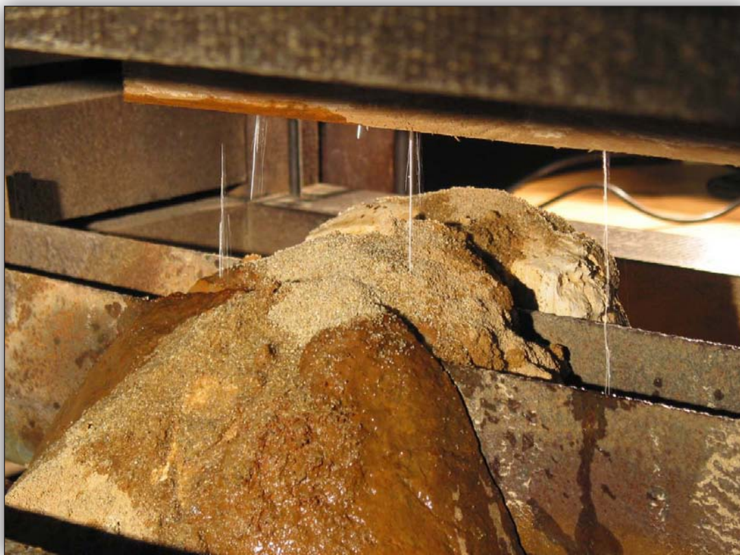
24- La vieja máquina de esmerilado de Schwerin. Mientras que la aplicación de la arena es manual, el agua es suministrada por un pequeño tubo.
