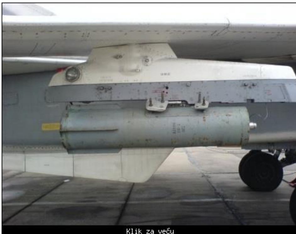
Klik za veću Die Leuchtbombe vom Typ SAB 250-200 an einem tschechischen Militärjet befestigt.
