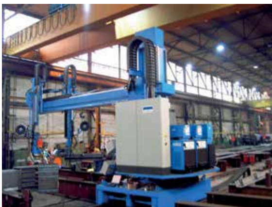
UP-Portalanlage zum Schweißen der Bleche © Oerlikon Schweißtechnik GmbH
