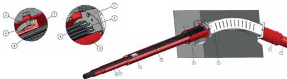
25 Umlenkung der Litzenspannglieder © Leonhardt, Andrä und Partner AG/Schimetta Consult Ziviltechniker GmbH/Dissing + Weitling architecture a/s
