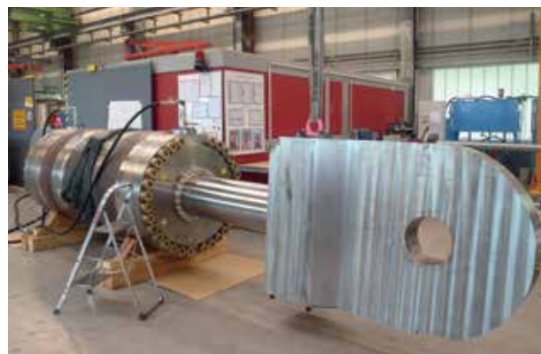
13 Längsverriegelungszylinder im Werk © Stefan Reitgruber
