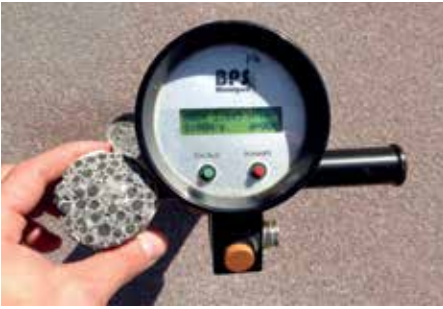
13 Haftzugprüfung im Rahmen der Eigenüberwachung © Zilch + Müller Ingenieure GmbH
