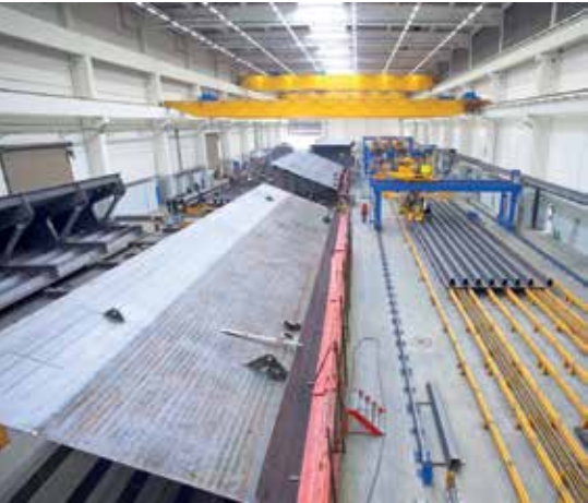
6 Halbautomatisierte Umlauffertigung im Werk © Firmengruppe Max Bögl
