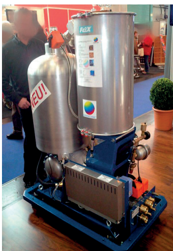
Mikrokogenerační jednotka na dřevní pelety
