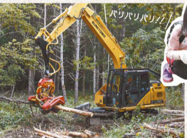
伐採から枝払い、玉切りまでの作業を一貫して行う高性能林業機械ハーベスタ。思わず息を飲む圧巻の迫力でした
