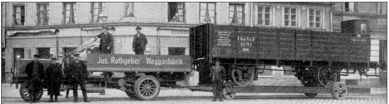
Transport eines Eisenbahn-Güterwagens mit 8,8 t Eigengewicht mit einem 38 PS Büssing-Lkw der Subventionstypen 1910 1
