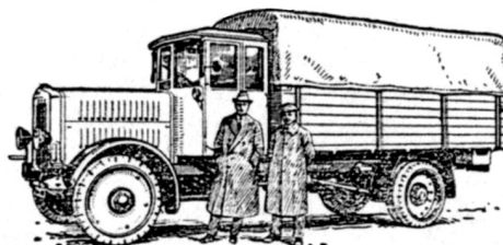
Büssing-Fünftonner mit 80/90 PS Sechszylindermotor
