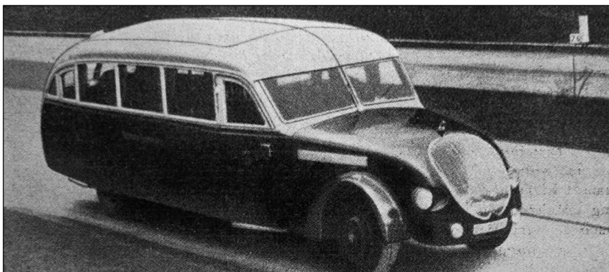
Büssing 502 N mit 6-Zylinder-Motor 1935
