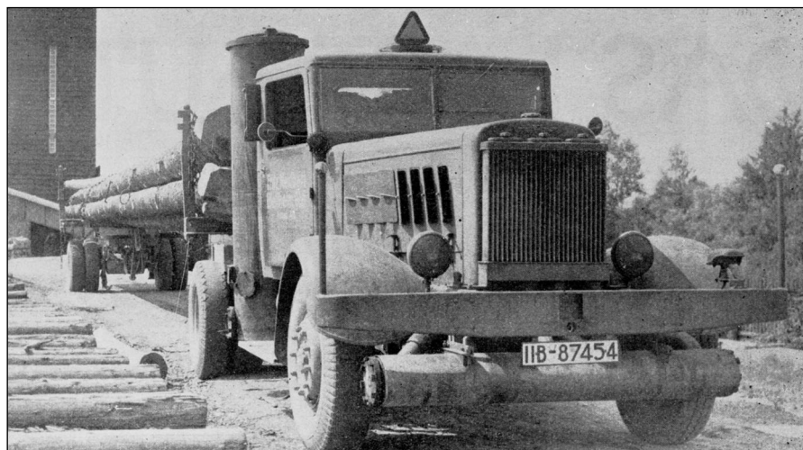
Büssing mit Holzgas-Generator 1936 A
