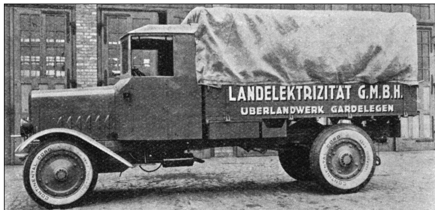
4-t-Büssing mit Kardan und Luftbereifung 1920
