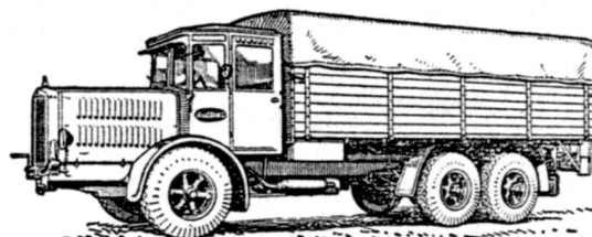
Büssing-Sechsradwagen mit 100/110 PS Sechszylindermotor
