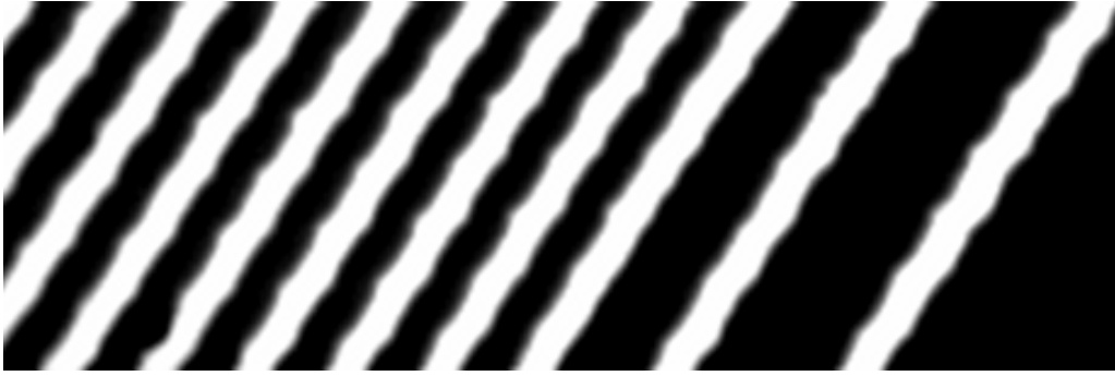
Abbildung 4.7: Aufnahme einer Glas Maske mit einem Laserabtastungsmikroskop (LSM). Der Ausschnitt zeigt einen Teil einer Periode des Sinus-förmigen Intensitätsverlaufs. Die Welligkeit der Kanten entsteht, wenn das Schreiberaster des Elektronenstrahls nicht parallel dazu verläuft.
