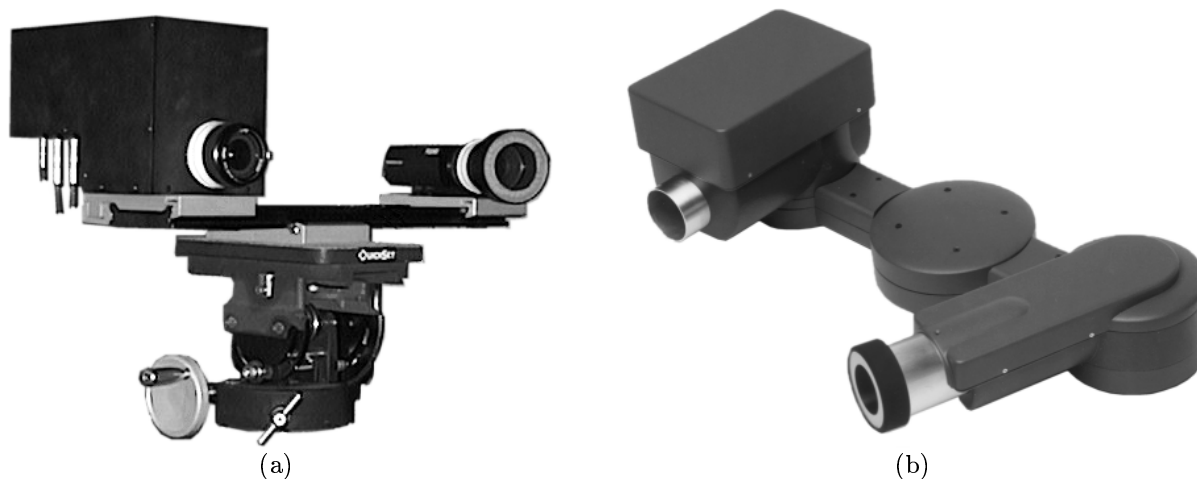
Abbildung 1.1: Der Ganymed -Messkopf bestehend aus Kamera, Projektor und Ringlichtquelle. In a) ist der Prototyp aus dem Jahr 1997 dargestellt, b) zeigt den Sensor im Design-Gehäuse von 1999. Die Konstruktion des Gehäuses erlaubt die Konfiguration des Sensors für unterschiedliche Messvolumina und -abstände ohne Austausch von Gehäuseteilen oder Änderung der Verkabelung.
