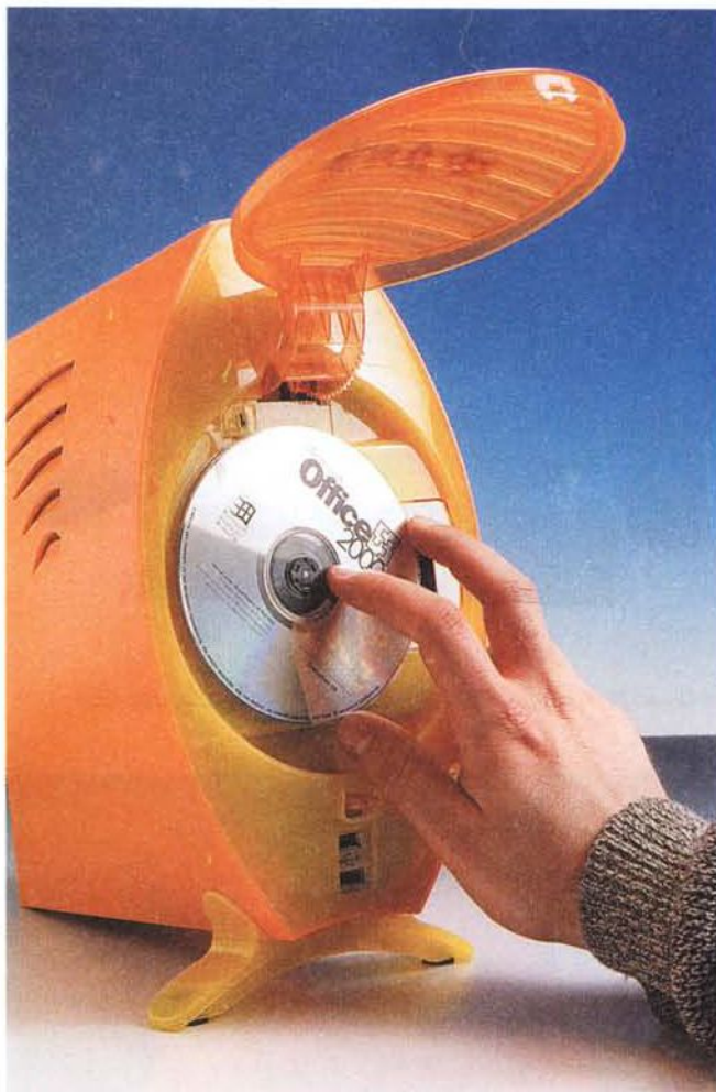
Il coperchio del vano CD-ROM si apre verso l'alto quando si preme il pulsante.
