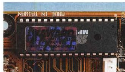
Un flash BIOS di AWARD con la sua batteria tampone.
