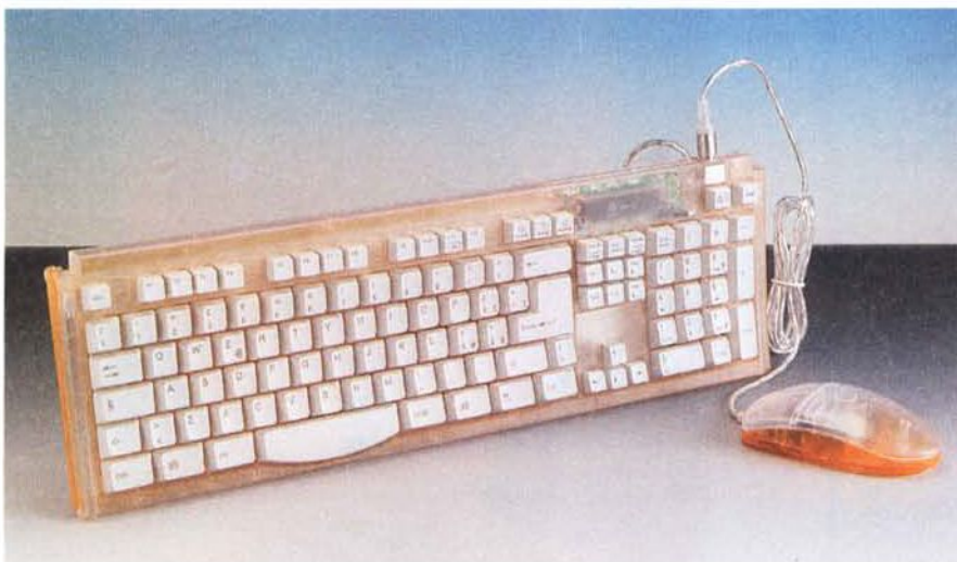
Particolare della tastiera con la presa PS/2 per il mouse: la tastiera colloquia con il PC tramite un bus USB, ma integra il supporto per il mouse PS/2 in modo tale da lasciare libera una ulteriore porta USB sul PC. Si noti la differenza dimensionale dei tasti funzione e la posizione del tasto di spegnimento.
