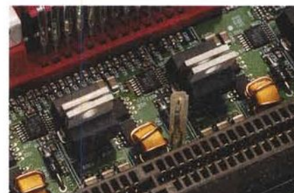
Il sensore di temperatura che controlla il funzionamento della ventola del processore.
