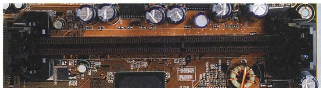
I due slot: a destra, lo SlotA per la CPU Athlon, in basso lo Slot1 per i processori Pentium-II e Pentium-III Intel; si noti come il connettore sia praticamente identico, solo "specchiato", in modo da inibire l'inserimento di CPU diverse da quelle compatibili.
