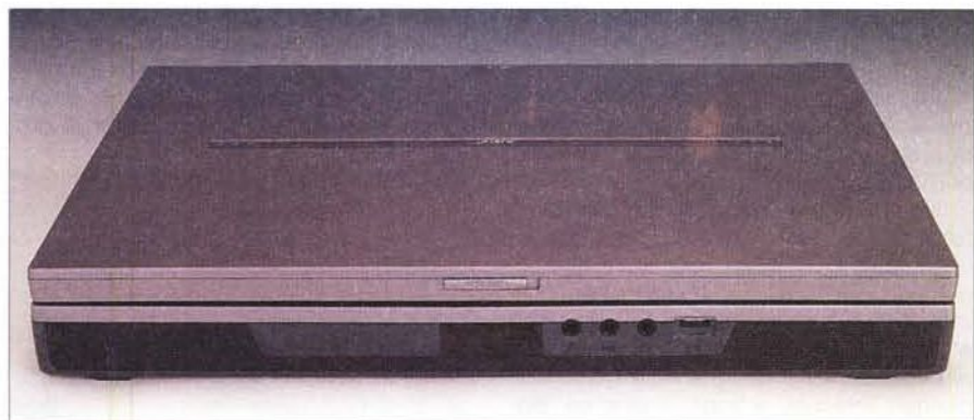
La 'mascherina' del portatile con i connettori 'multimediali' concentrati sul frontale.
