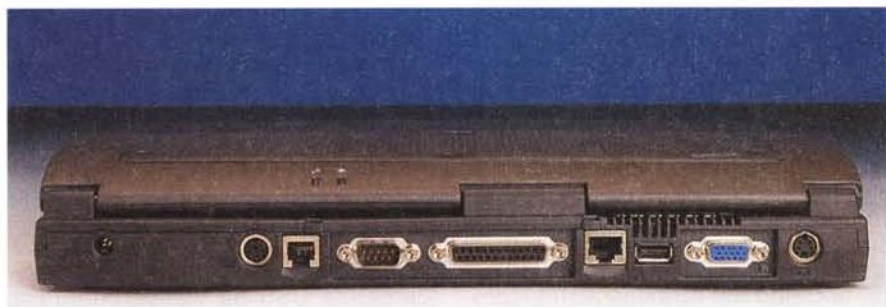
Il retro, come tradizione, ospita le porte di connessione prive di sportellino di protezione. Da notare il connettore S-video sulla destra e l'uscita della scheda di rete integrata.
