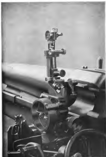
Panoramafernrohr Trommel-Visiereinrichtung (Kruppsche Haubitze).
