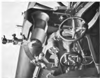
Panoramafernrohr-Stangen-Visiereinrichtung (Kruppsche Haubitze).
