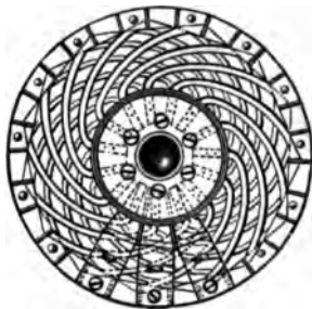
ARMATURE OF SIEMENS DYNAMO.
