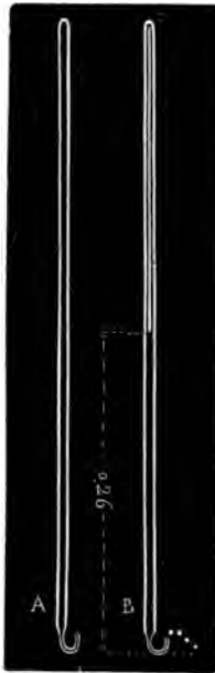
Tube barométrique témoin de M. Janssen. (Page 183.)
