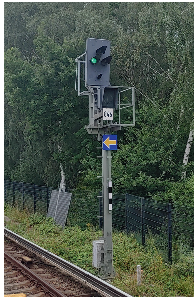
Abb. 6: Blocksignal mit ws-sw-sw-sw-weiße Mastschild und Ne 14
