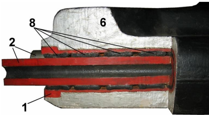
Abb. 5.26: Verbinderkette (1: Kettenglied, 2: Kettenbolzen, 6: Polster (hier: Gummi um gesamtes Kettenglied vulkanisiert), 8: Gummiringe)
