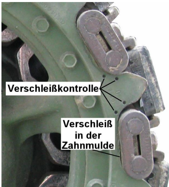
Abb. 5.6: Verschleißkontrolle mittels Verschleiß- kontrollbohrungen (Mindestabstand Boh- rung - Zahnflanke: 1 mm)
