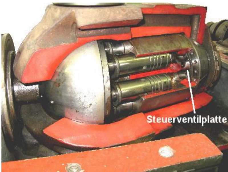
Abb. 4.13: Schnitt durch eine Axialkolbenpumpe
