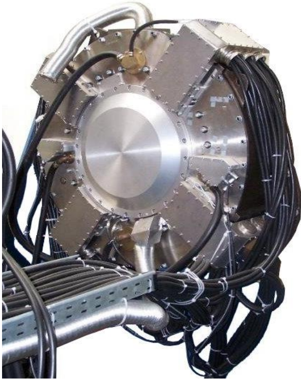
Abb. 3.27: Dauermagnetmotor der Fa. Magnetmotor (900 kW, Durchmesser etwas mehr als 1m, ca. 1500 kg)
