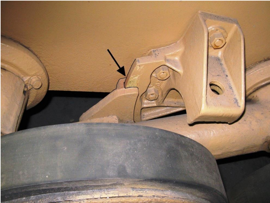
Abb. 5.16: Sicherung gegen Schwingarmverformung
