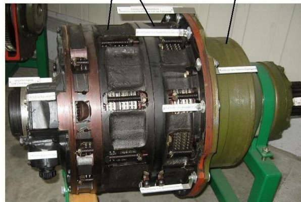
Abb. 4.6: Schaltgetriebe des KPz T72 (Dienstvorschrift der NVA [6]; rechte Fahrzeugseite)
