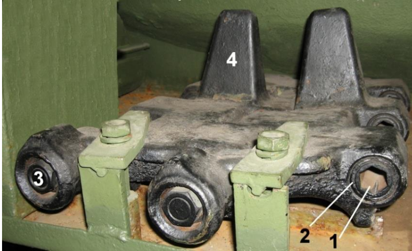
Abb. 5.23: Torsionsvorgespannte Scharnierkette (GMG-Kette; 1: Metallhülse, 2: Gummiringe, 3.: Kettenbolzen, 4: Mittenführung)
