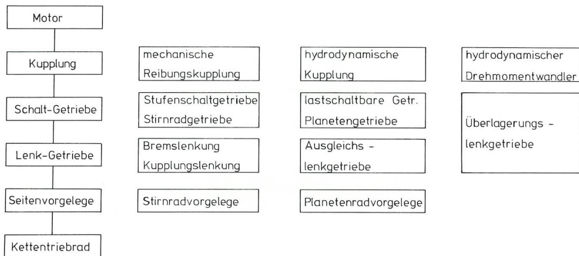
Abb. 3.1: Elemente des Antriebsstranges im Kettenfahrzeug
