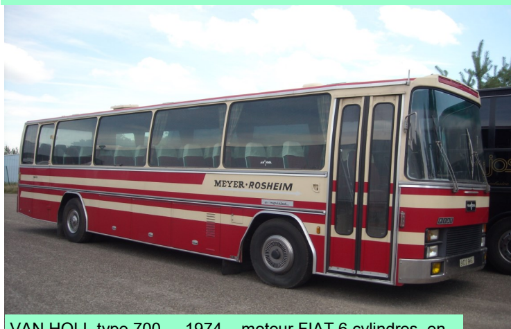
VAN HOLL type 700 - 1974 - moteur FIAT 6 cylindres, en position arrière, le véhicule a effectué toute sa carrière aux Autocars Meyer de Rosheim (Bas Rhin), il est dans un état de conservation exceptionnel
