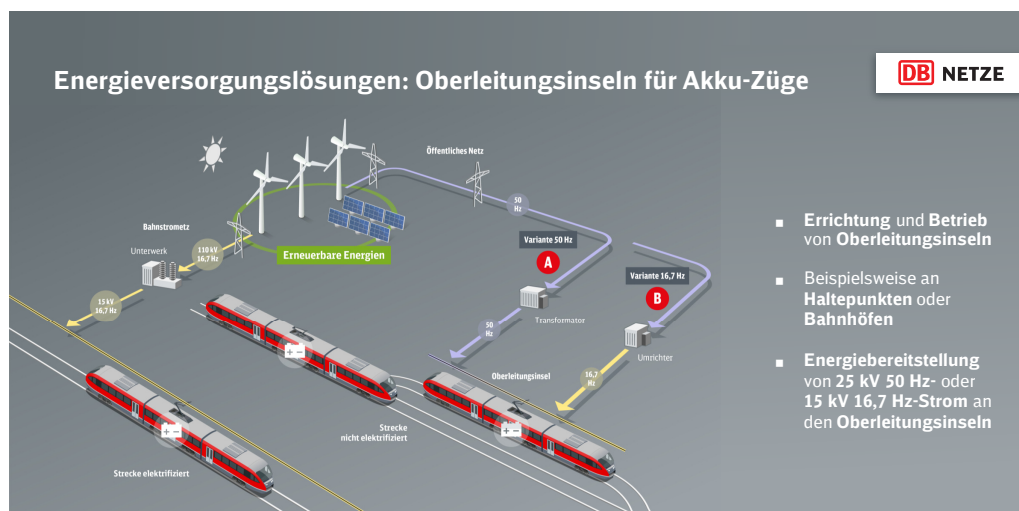
Abbildung 7: Darstellung der möglichen Umsetzungsvarianten von Nachladeabschnitten bzw. Nachladepunkten. Von den oben genannten drei Varianten sind in dieser Grafik nur die erste und dritte dargestellt. 12
