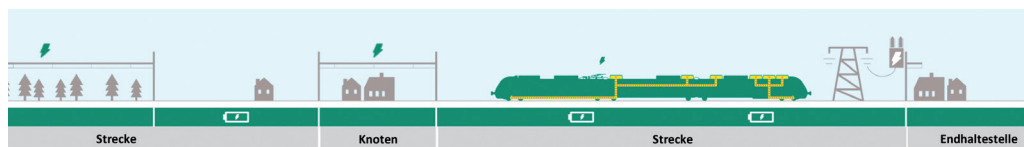
Abbildung 13: Beispielhafte Darstellung der Teilelektrifizierung mit der Verlängerung bestehender Oberleitung (links), Oberleitungsinsel (Mitte) und der punktuellen Ladestation am Endpunkt (rechts). 22
