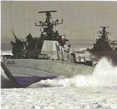
את השלדן מנייה מערכת נט המאפשרת ביצוע חמוצים חדים על ידי הפניית הרום לכיוונים שונים בדומה למטוס סילון. על גבי השלדג מותקנת מערכת יזר אוטומטית שיכולה לעקוב אחר מסות מסונחים רחוקים ולפתוח באש מדויקת תוך כדי תמנה במהירות במה ובכל מזג אוויר. צילום: צפן בן אליעזר
