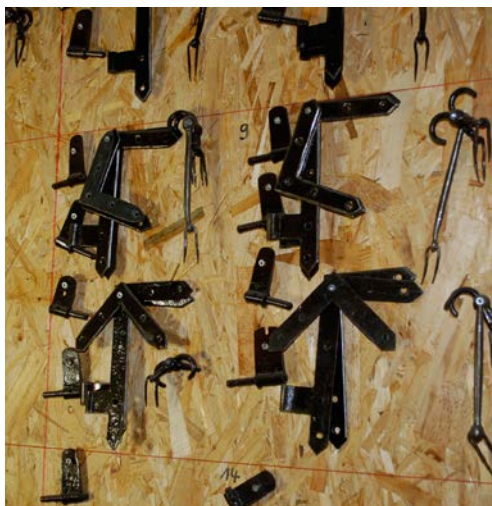
Hjørnejern, hengsler og vindushasper er viktige detaljer på gamle vinduer. Disse trenger jevnlig vedlikehold for ikke å ruste.
