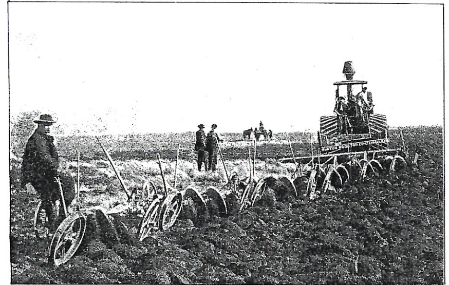
Bild 6.2.1/2: Ein Dampfschlepper zieht einen Pflugsatz bestehend aus 6 Scheibenpflügen (USA um 1910)
