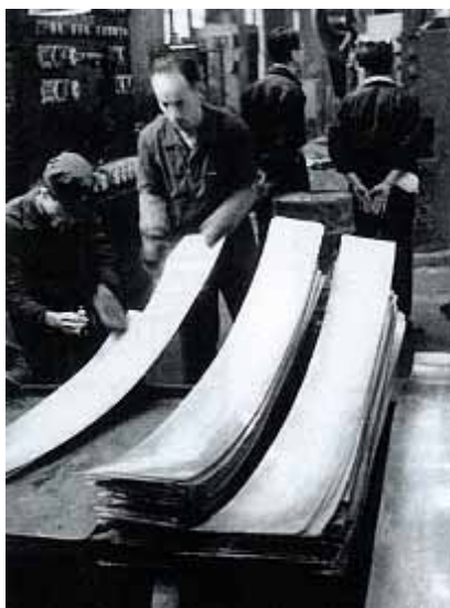
昭和30年代後半まで、仕上板の板厚を1枚ずつ計っていた
