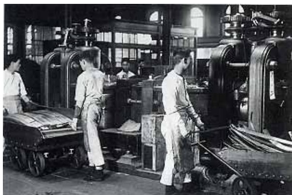
2段式冷間圧延機
