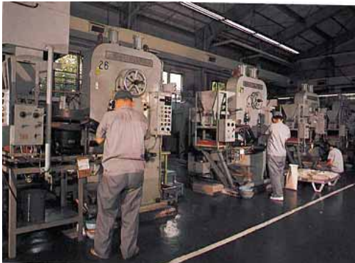
360 トン4本打圧印機
