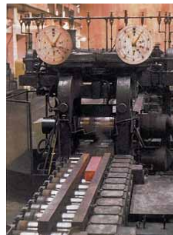
225kw 可逆式熱間圧延機(昭和30年)
