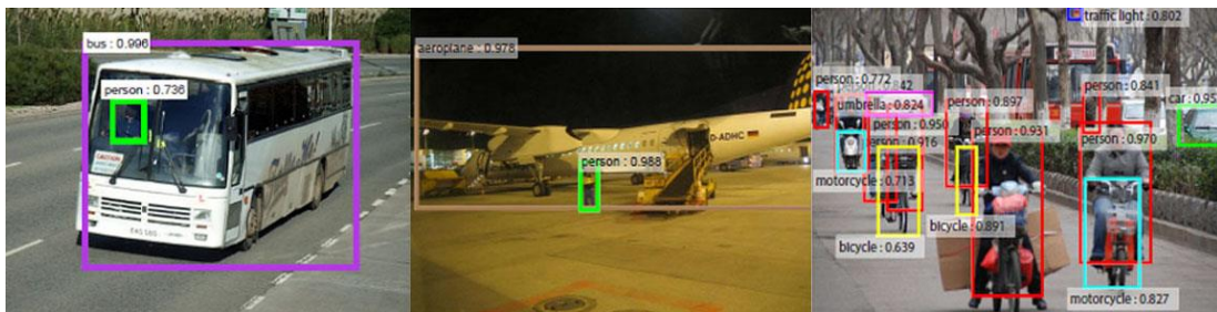
Abb. 3.18 Objektklassifizierung in Videodaten mit ML-Modellen
