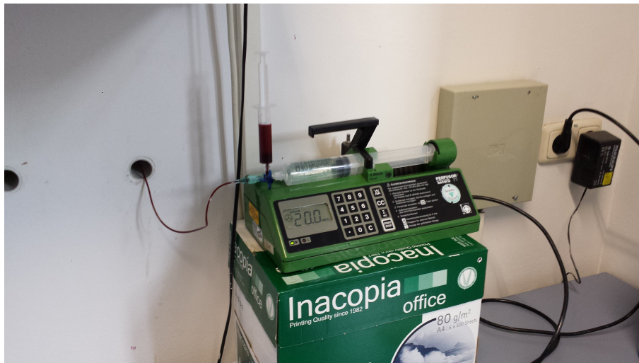
Abbildung 4.3: Versuchsaufbau aus der Perspektive der Versuchsleiterin. Abgebildet ist das Schlauchsystem mit dem Perfusor und dem Drei-Wege-Hahn.
