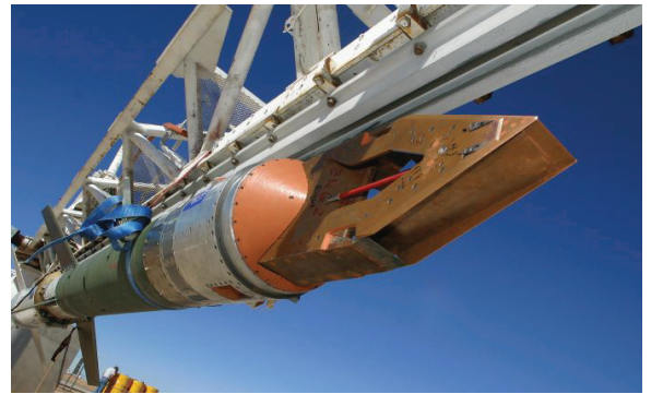
Abb. 1.11: HyShot: (a) Schematische Skizze des mit Treibstoff versorgten Strömungskanals (aus [199]) und (b) Versuchsträger montiert an eine Orion-Terrier-Trägerrakete (aus [36])
