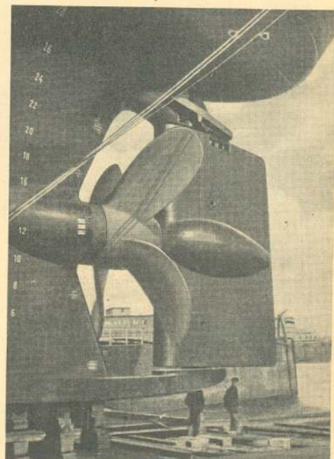
Ruder mit Costabarne des 47 000-t-Tankers „Al-Malik Saud Al-Awal“ (erb. 1954 von den Howaldtswerken Hamburg).
