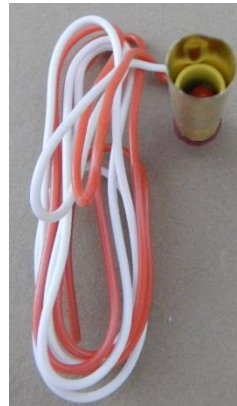
Abb. A-Anzünder mit Metallhülse (nicht zu verwechseln mit einem Sprengzünder)
