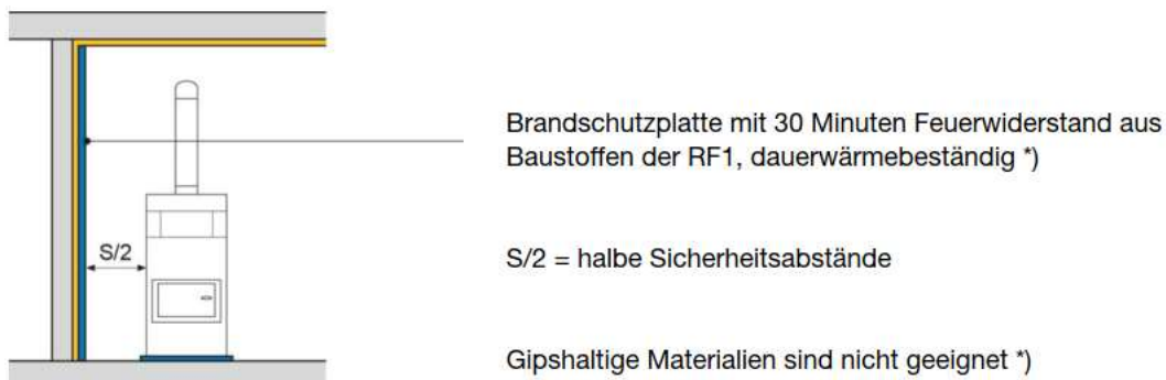
Abb. 37 Brandschutzplatte mit 30 Minuten Feuerwiderstand aus Baustoffen der RF1
