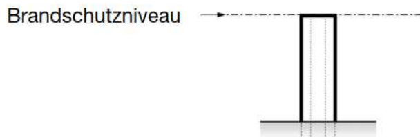
Abb. 63 Mindesthöhe von Abgasanlagen (Brandschutzhöhe)
