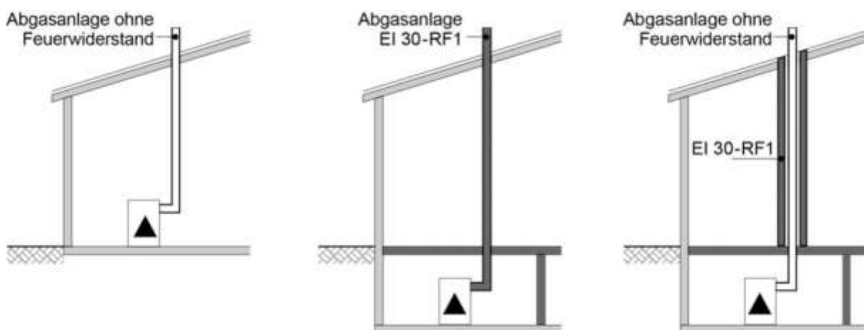
Abb. 75 Beispiele eingeschossige Bauten, innerhalb von Wohnungen und «Gebäuden mit geringen Abmessungen»
