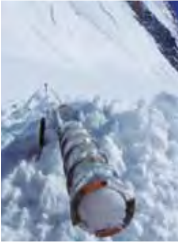
Abb. 2.1: Bohrkern im Gletscherfirn
