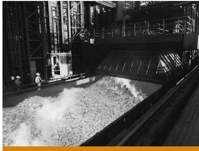
Abb. 1: Fast 40 Tonnen glühender Koks im Löschwagen – rechts im Bild die Absaughaube der Koksüberleitmaschine
