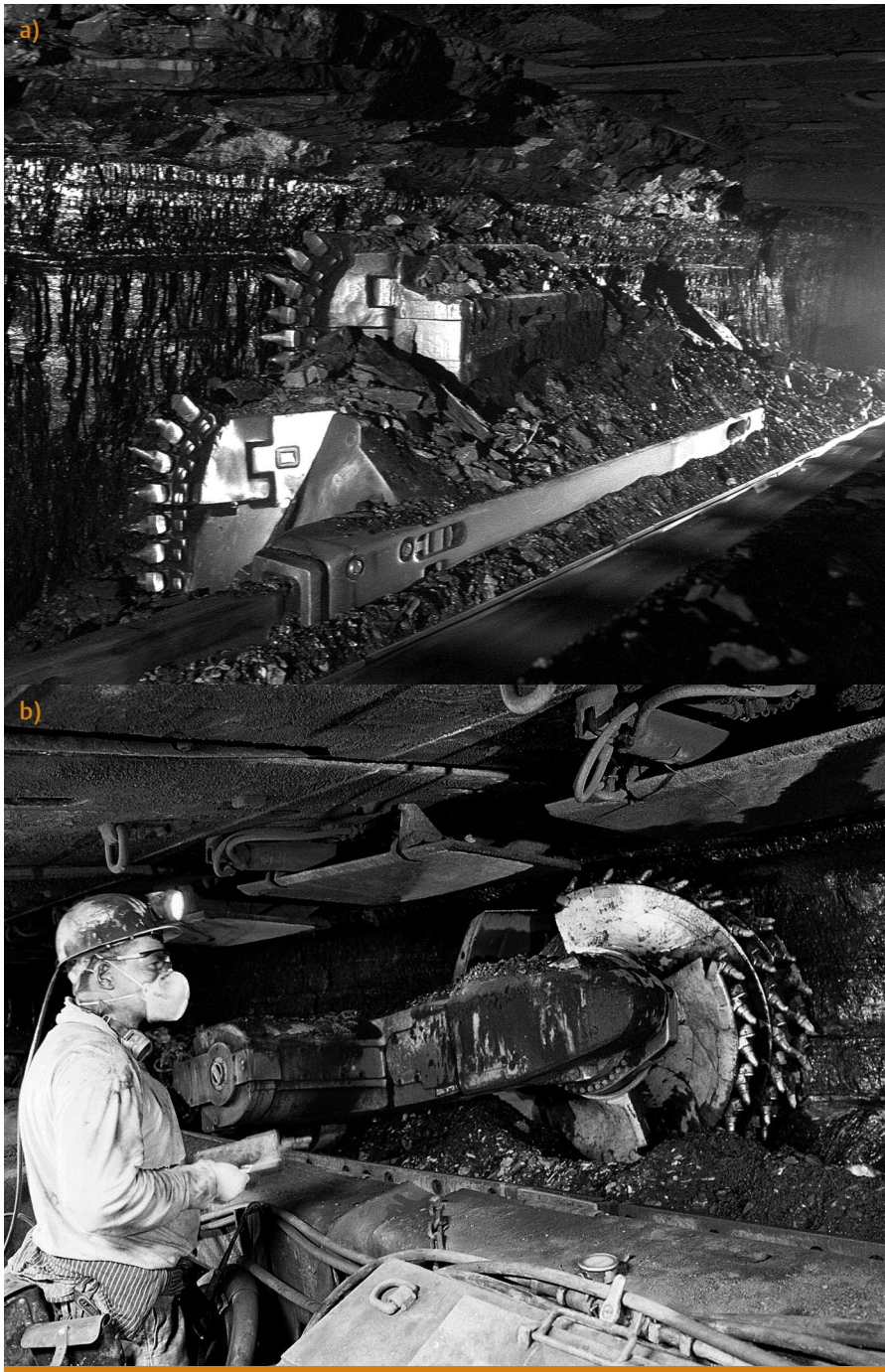
Abb. 3: Steinkohlenabbau im untertägigen Streb: a) Hobel, b) Walzenschrämlader (Foto: RAG, Herne)
