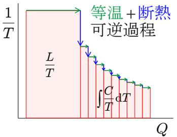
温度変化しない伝熱が加熱途中に生じる1次相転移(固体S→液体L→気体G)がある場合の $\Delta S$ は以下のように表され, 第3法則の検証に用いられている。(参考13参照)
