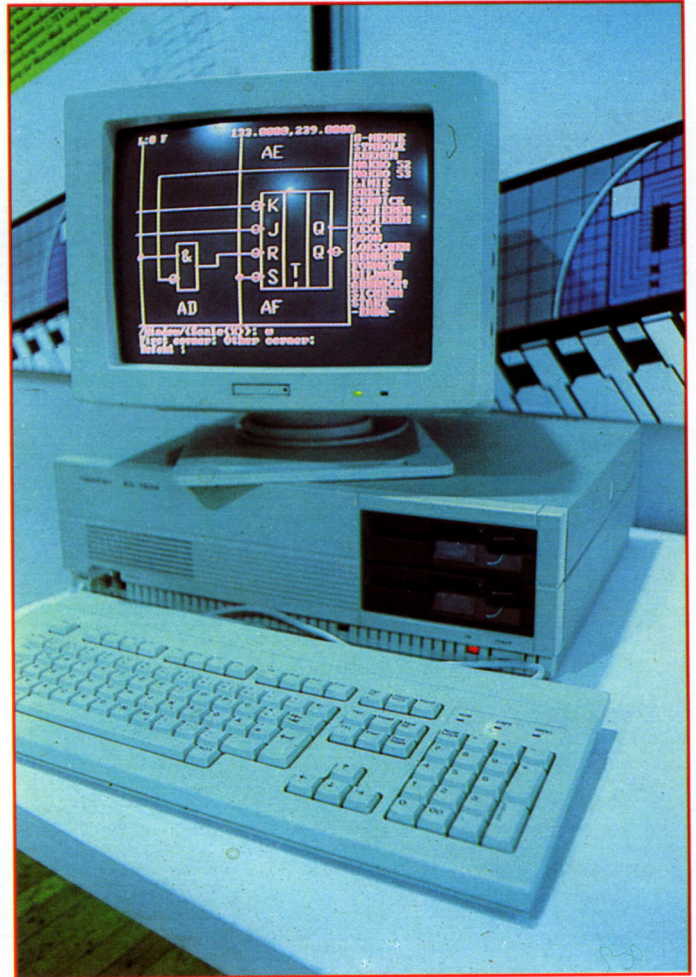
6 Teilentwurfsarbeitsplatz für Gate-Arrays mit EC 1834
