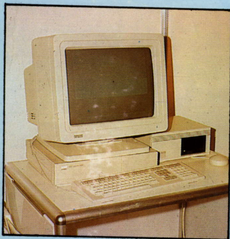
DECstation 3100 mit zusätzlichem Kassettenmagnetbandlaufwerk TK50Z
