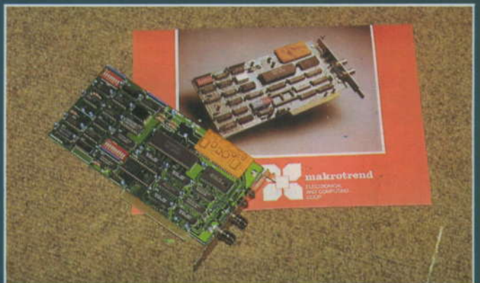
4 ARCNET-kompatible LAN-Interfacekarte von Makrotrend
