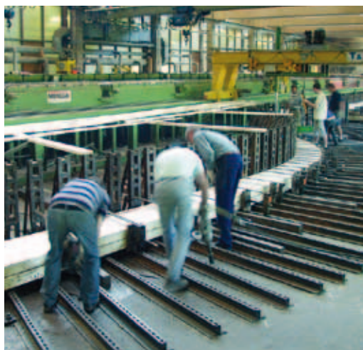
Abbildung 4.24: Gekrümmtes Brettschicht- holz im Pressbett
