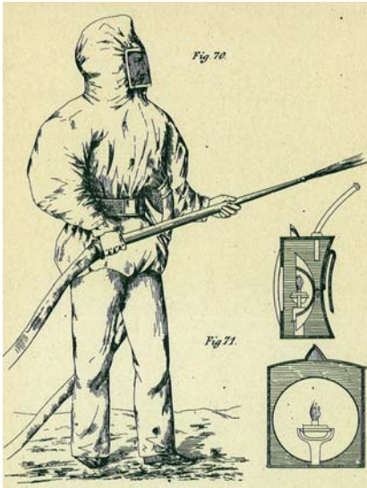
L'aparell Paulin, una innovació important en la lluita contra incendis de mitjan segle XIX. La làmina es va publicar al Tratado de extinción de incendios , d'Antoni Rovira i Trias. © Biblioteca de Catalunya
